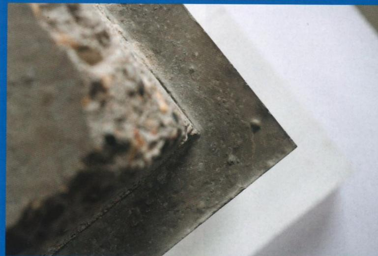
mette di realizzare delle micro-solette, con spessori ridotti, variabili da 5 a 10 cm, molto rigide e capaci di redistribuire i carichi accidentali in maniera molto più efficace rispetto ad una soletta tradizionale, solitamente dell'ordine di 20 cm.
